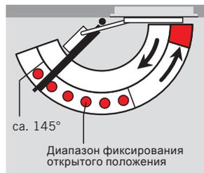
Механический фиксатор открытого положения позволяет удерживать дверь в открытом положении точно при
