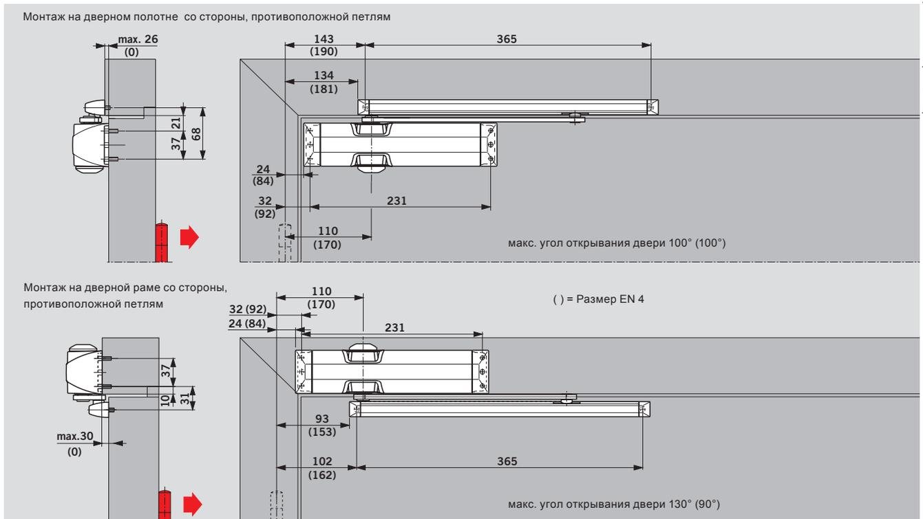
В зависимости от конструктивных условий определяется максимальный угол открывания двери.
