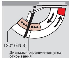
Ограничитель угла открывания легко устанавливается в скользящий канал. Регулируется в диапазоне от 80° до макс. 120°.
