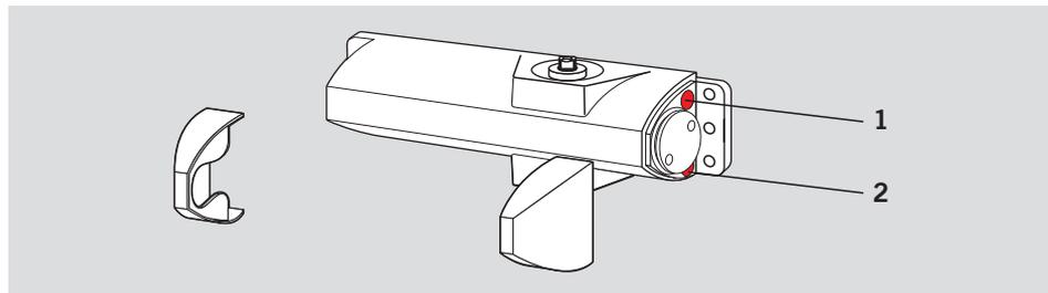
Скорость закрывания TS 90 Impulse регулируется двумя независимыми клапанами в двух диапазонах.
