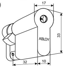
Возможно удлинить цилиндр с помощью накладок, шаг 5 мм, максимальная длина – 130 мм.
