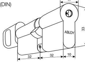
Возможно удлинить цилиндр с помощью накладок, шаг 5 мм, максимальная длина – 130 мм.
