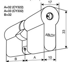
Возможно удлинить цилиндр с помощью накладок, шаг 5 или 10 мм, максимальная длина – 130 мм.
