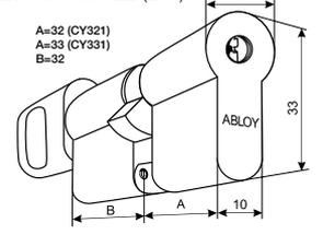
Возможно удлинить цилиндр с помощью накладок, шаг 5 или 10 мм, максимальная длина – 130 мм.
