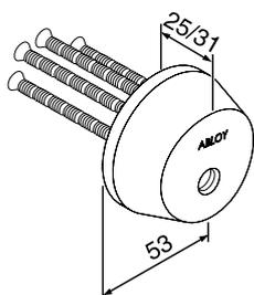
Цилиндр без поворотной кнопки (составная часть цилиндра CY001). Защитная скобянка из латуни с вкладышами из закаленной стали. Ключи – C, P, D, U, N
