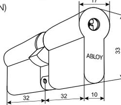
Возможно удлинить цилиндр с помощью накладок, шаг 5 мм, максимальная длина – 130 мм.
