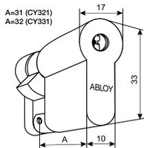
Возможно удлинить цилиндр с помощью накладок, шаг 5 или 10 мм, максимальная длина – 130 мм.
