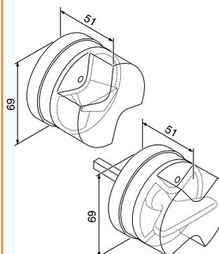
Поворотная кнопка для дверей эвакуационных выходов.
