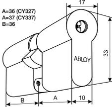
Возможно удлинить цилиндр с помощью накладок, шаг 5 или 10 мм, максимальная длина – 130 мм.
